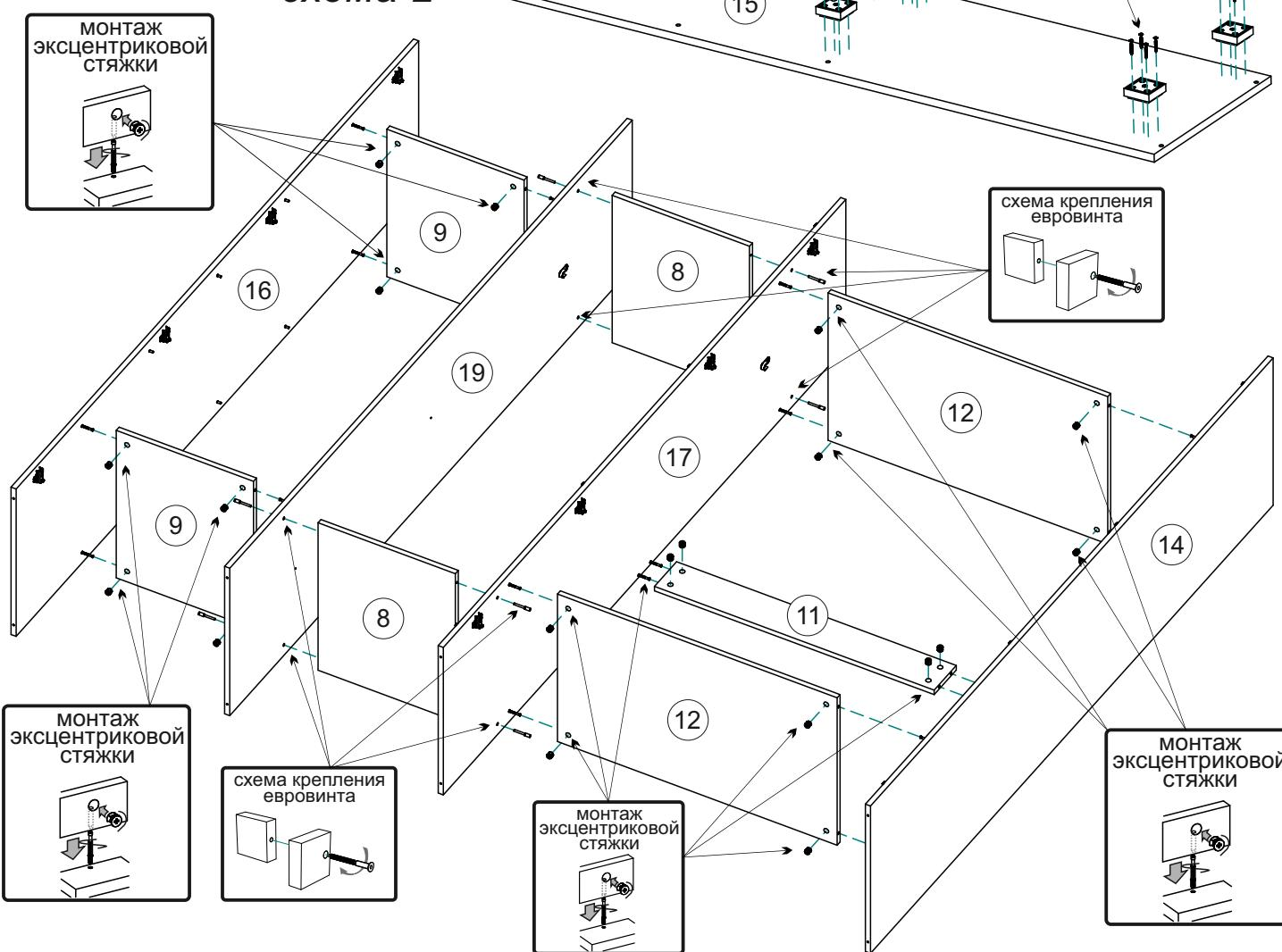
4. Евровинтами соедините крышки 15 с боковинами 14,16 и перегородками 17,19 (схема 3).
